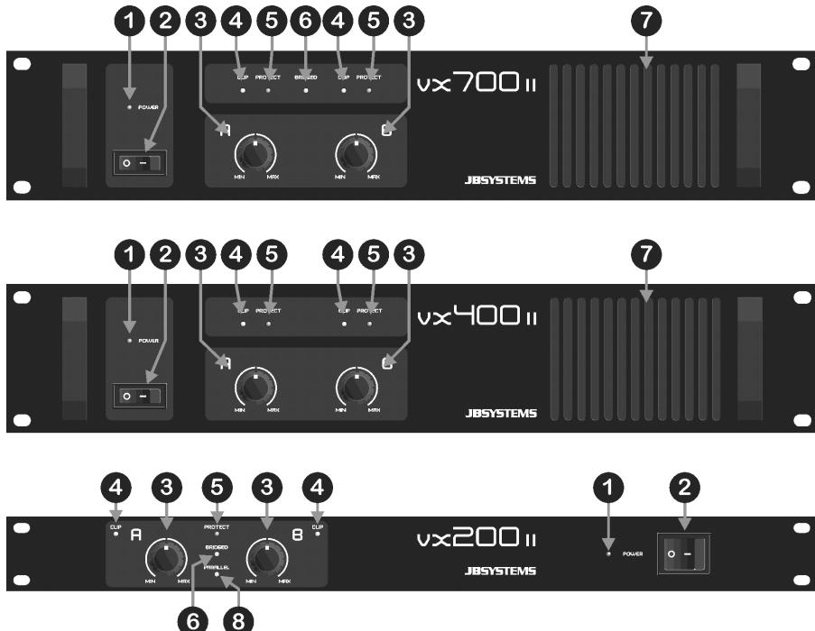
1. **POWER LED:** ce led bleu est allumé quand vous allumez l'amplificateur en utilisant l'interrupteur (2).
